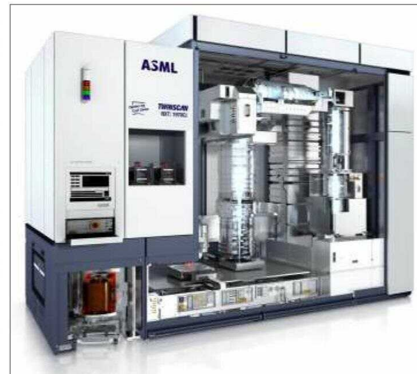
Ein Blick in eine der Belichtungsmaschinen. Mit ihnen werden Chips der neuesten Generationen hergestellt. Foto: ASML
