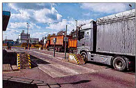
Die Lkw, die den Müll anliefern, werden bei der Einfahrt zum Heizkraftwerk und bei der Abfahrt gewogen. So wird die angelieferte Müllmenge ermittelt.
