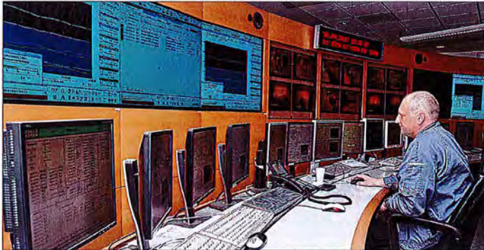
Der Leitstand der Müllverbrennungsanlage. Von dort aus wird die gesamte Anlage gefahren und überwacht. Per Maus-Klick kann Andreas Lenz immer auf alle Daten der Anlage zugreifen.
